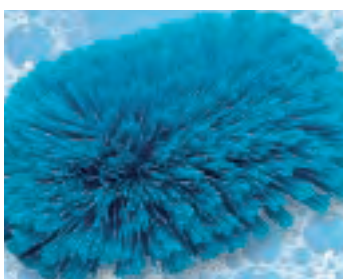
De vezels zijn verkleefd door langdurig gebruik – het gereedschap moet vervangen worden.
